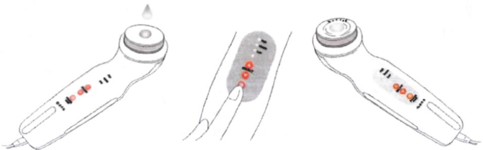
▲ Připojte síťový adaptér, položte spotřebič na rovný povrch a umístěte na ultrazvukový generátor několik kapek vody.
